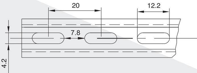
Рис.4 Размеры отверстий PM-15/5,5/П
