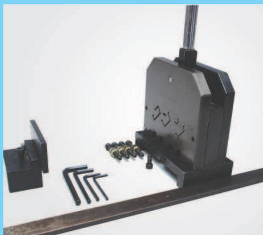
Настольный резак с пятью матрицами. Предназначен для ручной резки различных видов монтажного профиля необходимой длины. Инструмент не требует замены матриц для различных видов профиля.
